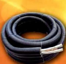
**Ανοξείδωτοι σωλήνες (σπιράλ)** AISI 316 L σε κουλούρα, με μόνιστη 13mm EPDM και εξωτερική μεμβράνη για προστασία από ακτίνες UV, πουλιά, κλπ. Περιέχει καλόδιο με μόνωση σιλικόνης για σύνδεση σε θερμοστάτες. Συνδέεται με ειδικά ρακόρ ιδιαίτερα ανθεκτικά σε υψηλές πλέσεις και θερμοκρασίες.
